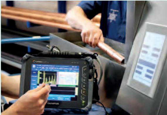
Selbst entwickeltes Ultraschallmessgerät
