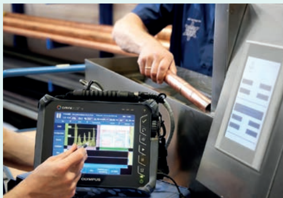
Selbst entwickeltes Ultraschallmessgerät
