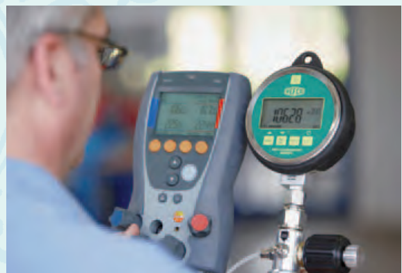
Kalibrierung der Monteurhilfen
